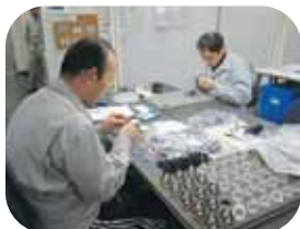
パッキン手貼り作業
